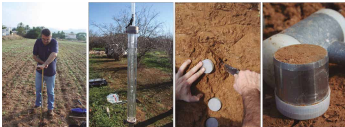
Figura 3: Algunes determinacions complementàries per la caracterització del sòl: conductivitat hidràulica mitjançant el permeàmetre de Guelph i obtenció de les densitats aparents d'un horitzó. Autor: ICGC
