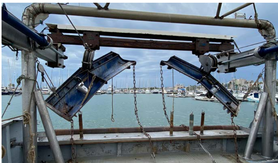
Portes sense contacte amb el fons en la modalitat d'arrossegament. Font: Direcció General de Política Marítima i Pesca Sostenible.
