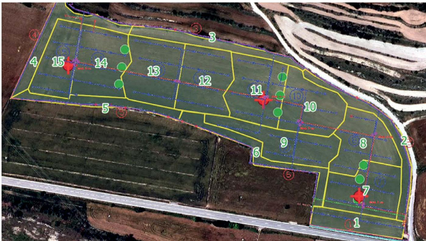
Esquema de la parcel·la pilot. Els polígons amb contorn groc i els números indiquen els sectors de reg. Els cercles vermells, els punts de monitoratge amb sensors. Els cercles verds, els mostresjos per a analítiques de sòl. Font: elaboració pròpia.
