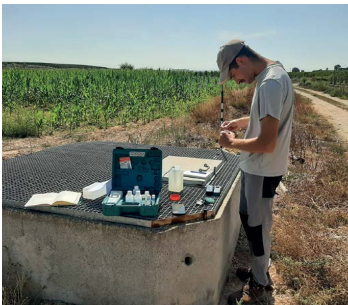
Presa de mostres de nitrats en un dels punts de desguàs d'una de les conques. Foto: Josep Maria Villar.
