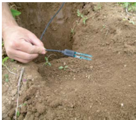
Sensor d'humitat de sòl a punt de ser instal·lat. Foto: INCAVI.
