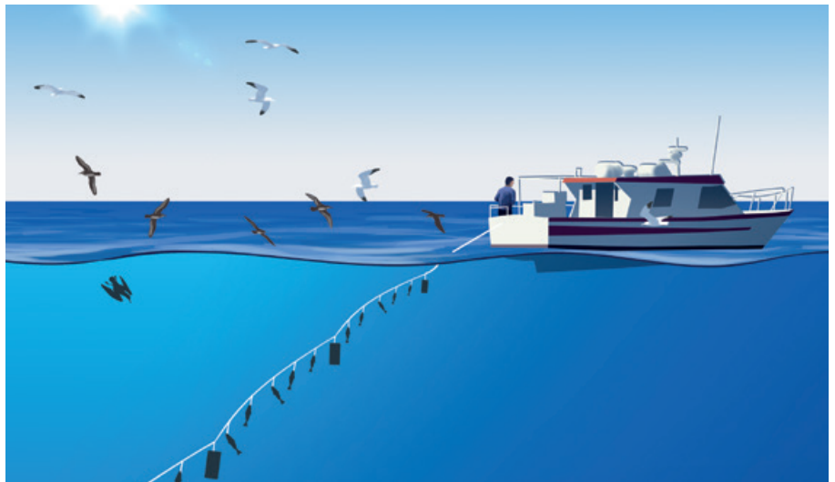
Figura 8. Addició de pes al palangre per reduir la taxa d'enfonsament dels hams escats. Il·lustrador: Martí Franch.
