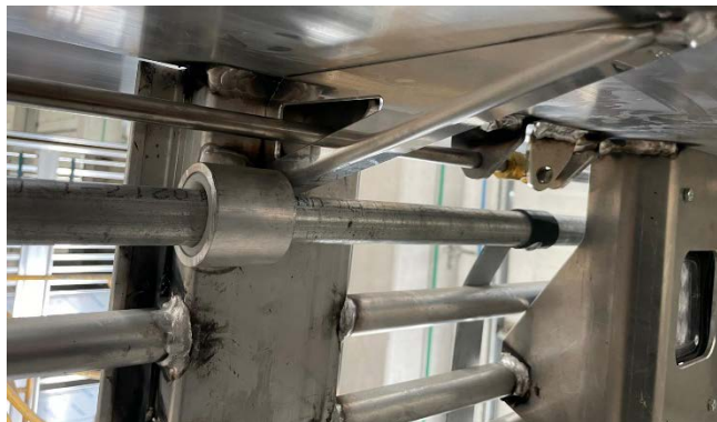
Foto 1. Foto de detalle del sistema de rociado en uno de los camiones de transporte de animales vivos con el sistema de autodesinfección incorporado (Foto: Albert – Carrosseries Molas).
