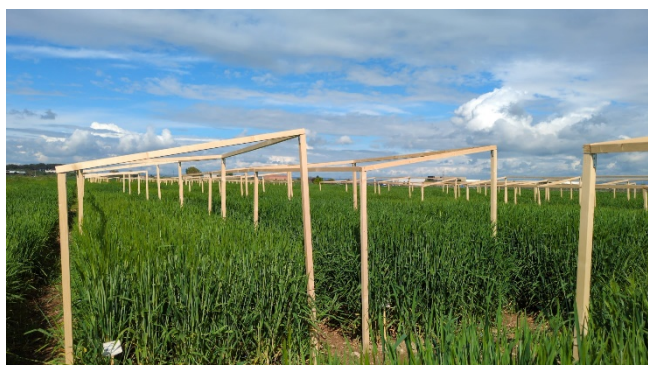
Foto 1. Vista general de uno de los experimentos donde se observan las estructuras sobre las que se montarán microinvernaderos que provoquen el golpe de calor por unos días durante el llenado de los granos
